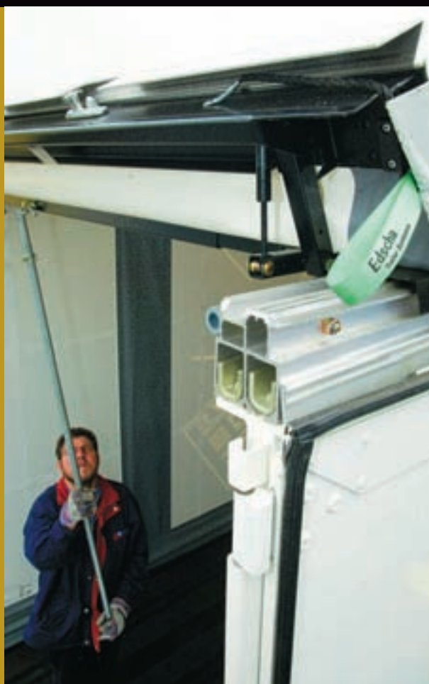
Skjutbara tak från EDSCHA Trailer Systems kan snabbt och enkelt öppnas av föraren när trailers ska lastas och lossas.
